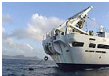
海底ケーブルの敷設作業
