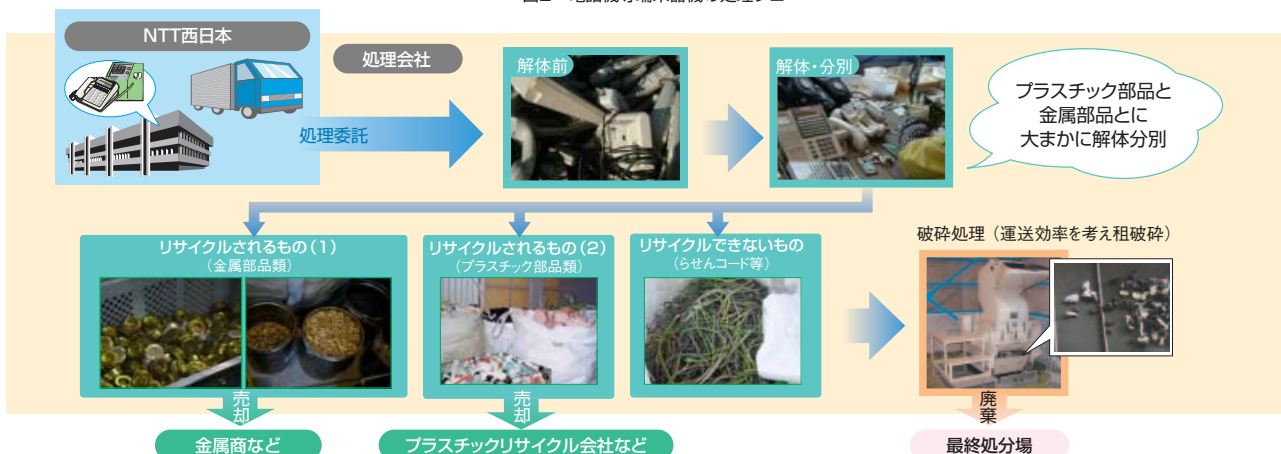
図2 電話機等端末器機の処理フロー
