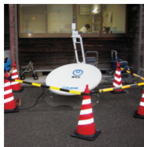
ポータブル衛星通信装置
