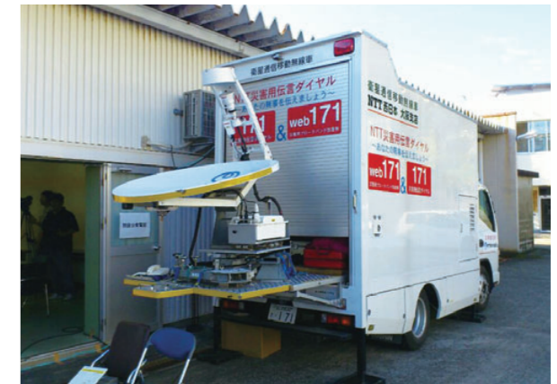
和歌山県：ポータブル衛星装置(車載型)により特設公衆電話を開設。
