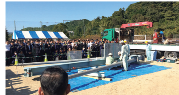
電柱強度試験の様相
